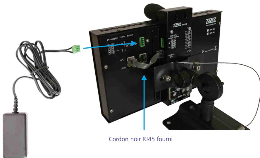
Il est recommandé d'établir tous les raccordements avant de mettre l'appareil sous tension.
